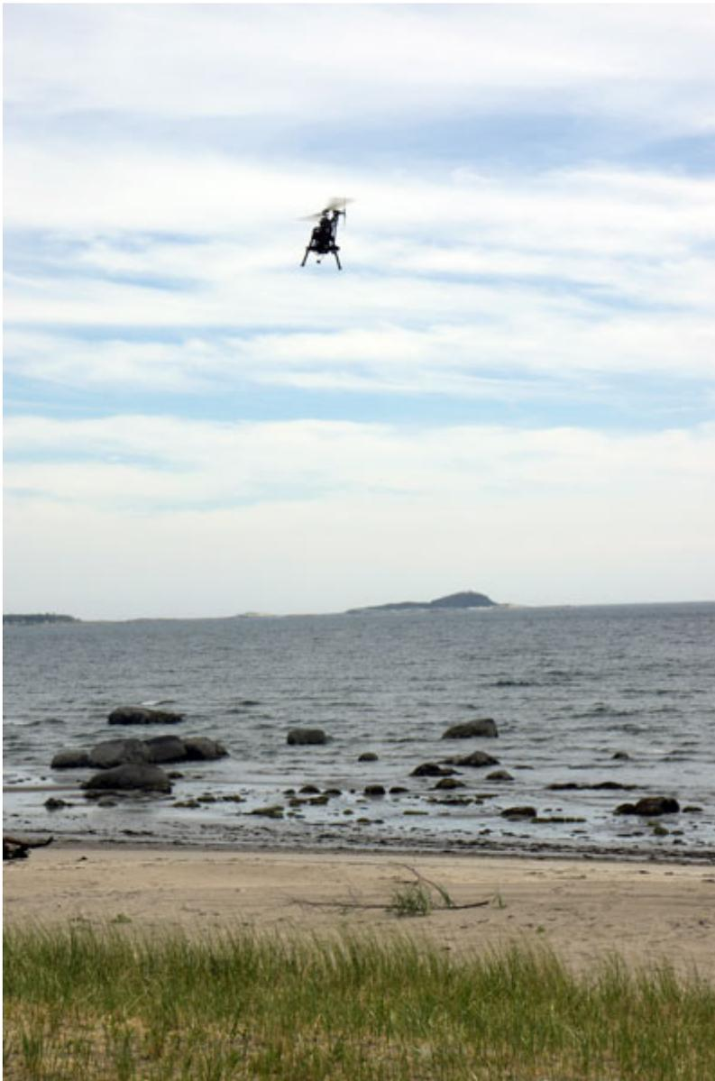
Légende : Un drone (*Responder* d'ING Robotic Aviation) équipé d'une caméra multispectrale survole la plage de Rivière-Pentecôte
